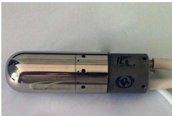
Рис.5. Гладкий цилиндрический приемник воздушных давлений без аэродинамической компенсации
