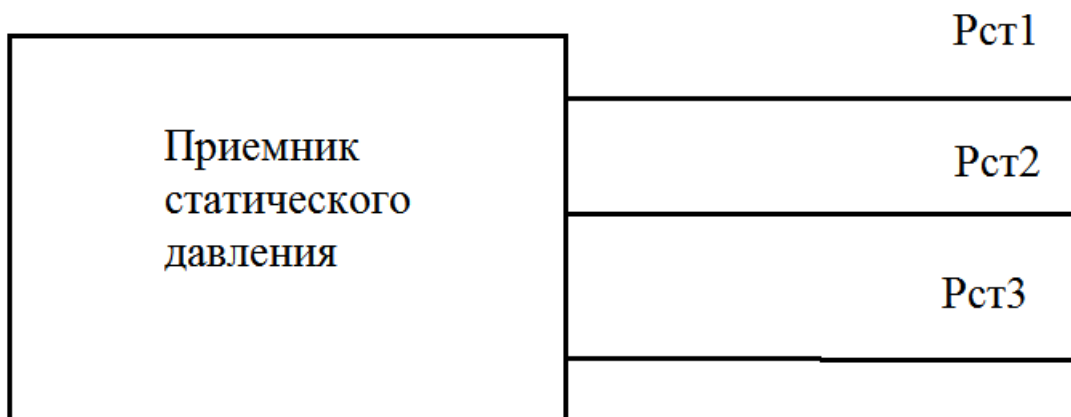
Рис.1 Схематичное представление приемника с тремя каналами восприятия статического давления набегающего воздушного потока
